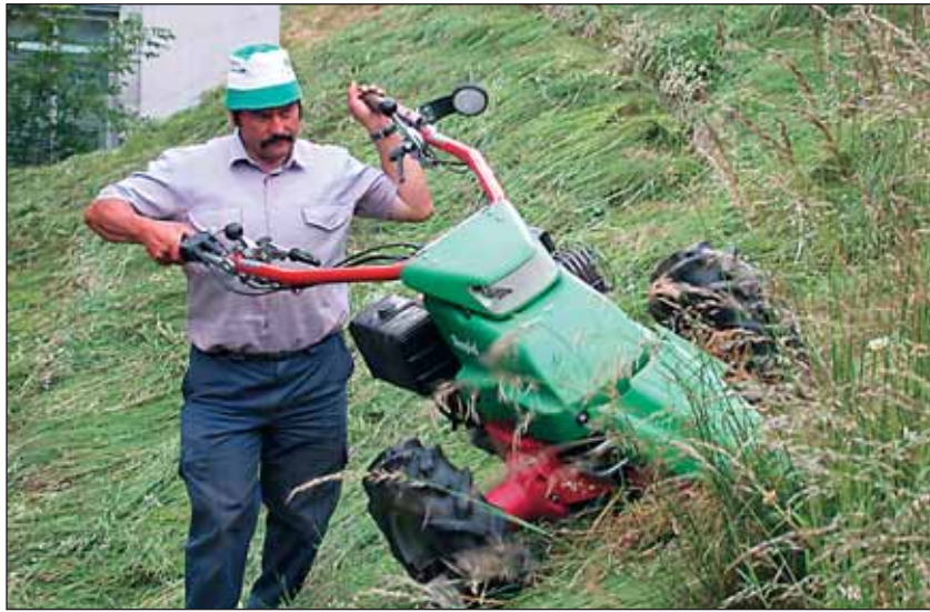
Hans-Jörg Wellig mäht mit dem einachsigen Motormäher in einer steilen Hanglage im Wohngebiet von Fiesch.
